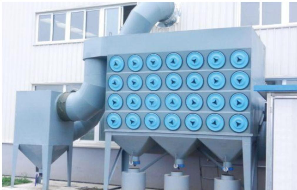
粉尘性质包括比电阻、粒度、真密度、瓢性、憎水性和水硬性、可燃、等。比电阻过大或过小的粉尘不宜采用电除尘器，袋式除尘器不受粉尘比电阻的影响；粉尘的浓度和粒度对电除尘器效率的影响较为明显，但对袋式除尘器的影响不明显；当气体的含尘浓度较高时，电除尘器前宜设置预除尘装置；袋式除尘器的型式、清灰方式和过滤风速取决于粉尘的性质（粒径、瓢性）；湿式除尘器不适合于净化憎水性和水硬性的粉尘；粉尘的真密度对重力除尘器、惯性除尘器和旋风除尘器的影响明显；对于新附性大的粉尘，易导致除尘器工作面猫结或堵塞，因此，不宜采用干法除尘；粉尘净化遇水后，能产生可燃或有危险的混合物时，不得采用湿式除尘器。
